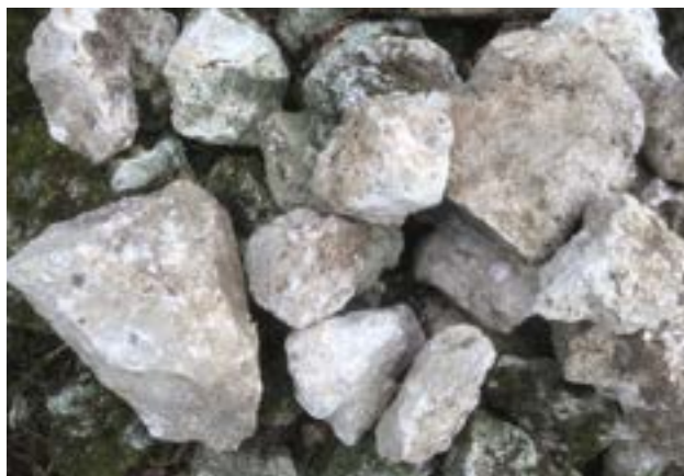
Moellons calcaires grossiers pour maçonneries enduites.
