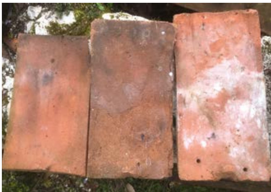
Tuiles plates avec un ergot d'accrochage.
