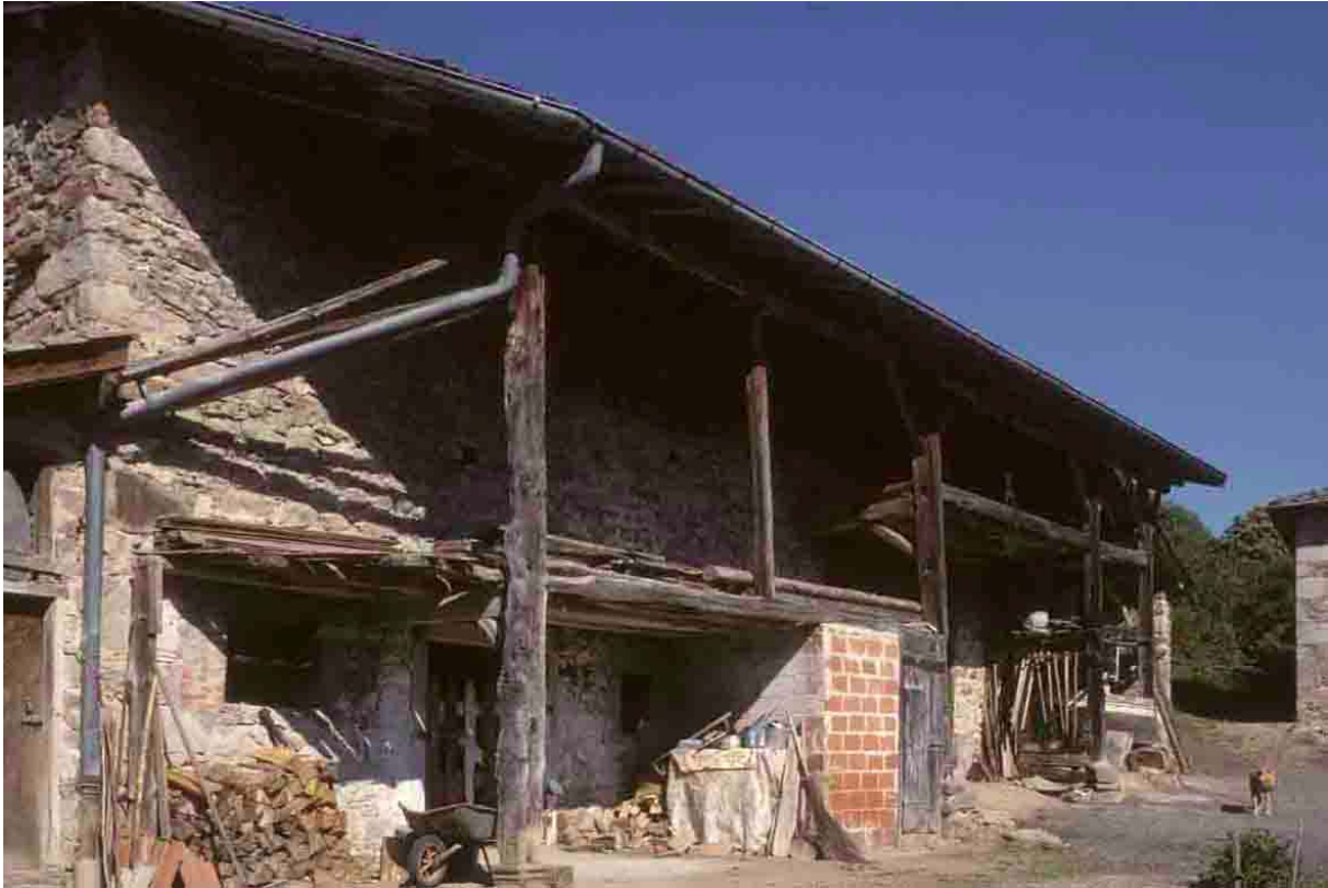
Arcon les Crosses (Loire), 1996. plus qu'une galerie, il s'agit d'une avancée de toiture destinée à abriter le foin de cette grange-étable. Mais le principe reste acquis. En général, dans le Forez, la galerie, portée sur piliers ou par une poutre sablière encastrée entre les deux maçonneries du retrait de façade, se situe entre le premier et le deuxième étage, celui du grenier.
